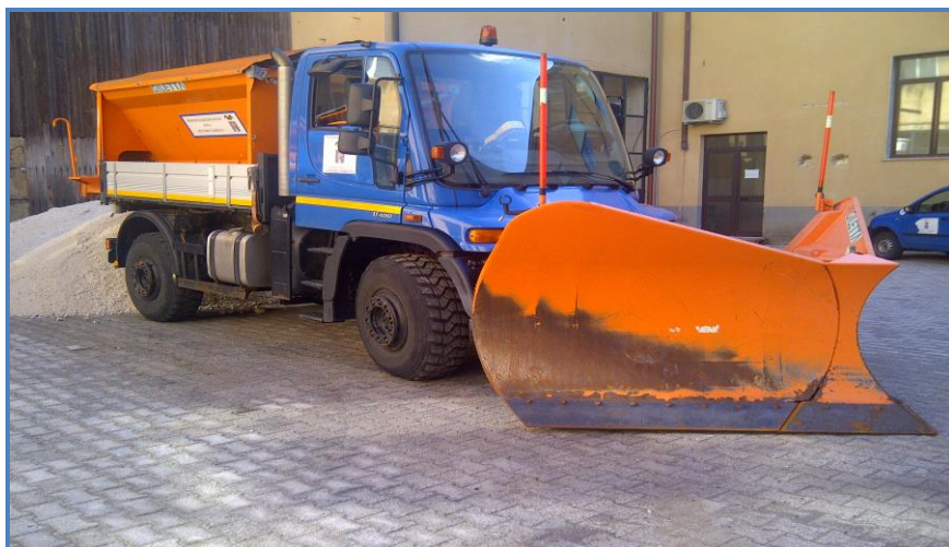
Fig. 4 - Unimog dotato di vomere e vasca per il sale in dotazione al Servizio 1
